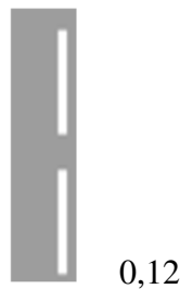
Znak P-7a linia krawędziowa -przerywana
